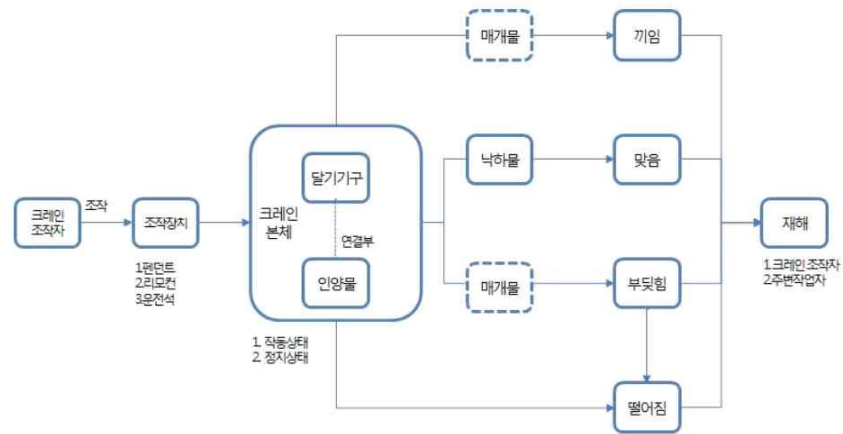
[그림 1-2] 크레인 재해 발생 모델
